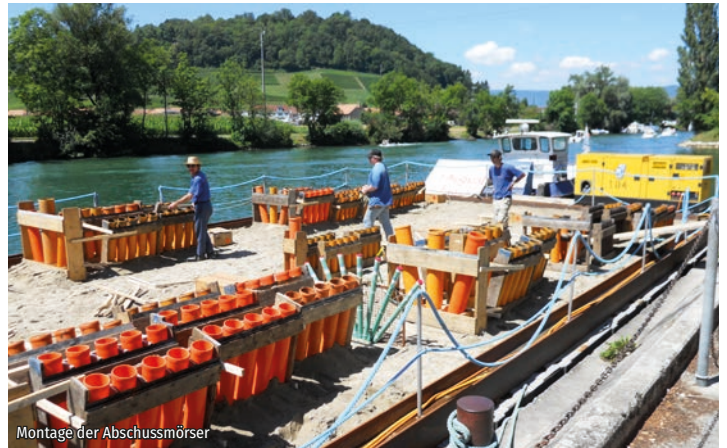
Montage der Abschussmörser
